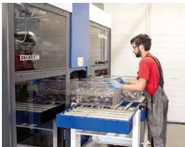
Turbo-Tec pracuje na dwie zmiany, myjąc 16 wsadów na zmianę, czyli 2 kosze na godzinę
