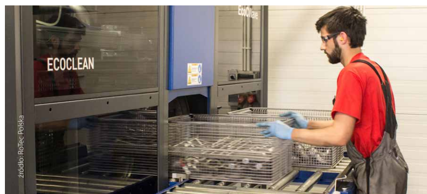
Różne części z różnymi zabrudzeniami i wymaganiami czystości są myte w myjce Ecoclean EcoCwave przed montażem
