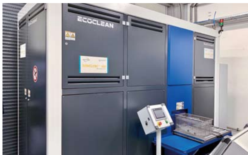
Automatyczna myjka próżniowa rozpuszczalnikowa EcoCompact produkcji Ecoclean
