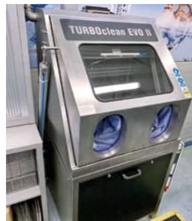
Wysokociśnieniowa myjka warsztatowa TURBOclean EVOII (ciśnienie 140 barów)
