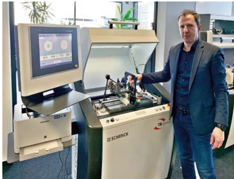
Wyważarka TBcomfort produkcji SCHENCK do wyważania wirników turbosprężarek samochodowych
